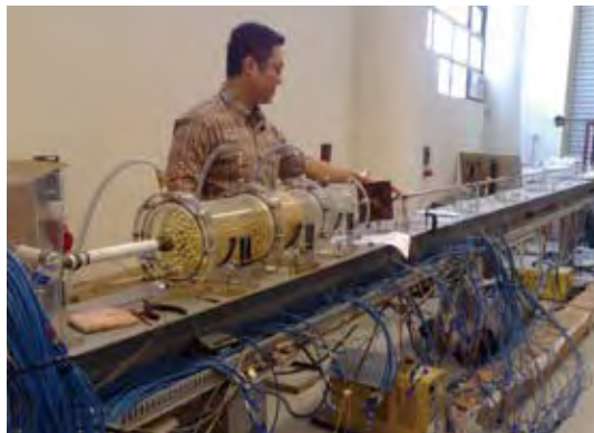
用於冷凍空調的 Micro fin tube 對流熱傳優化實驗
